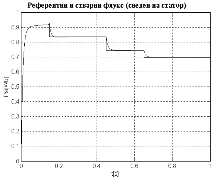
Сл. 3.4. Референтни и стварни флукс мотора код векторског управљања
