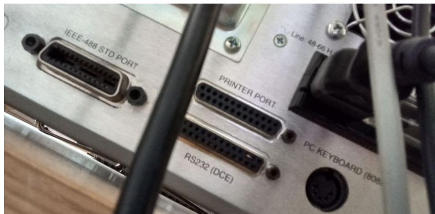
Слика 3 – Интерфејси лок-ин појачавача „SRS SR850 DSP“
