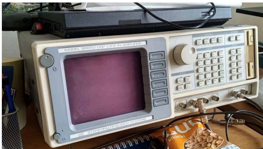
Слика 2 - Лок-ин појачавач „SRS SR850 DSP“
